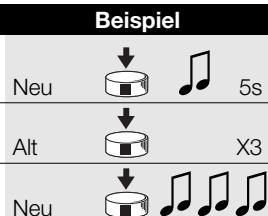
**Anmerkung:** Nach erfolgreicher Speicherung wird man 3 lange Bieptöne hören. Ist der Speicher voll (30 Sender), werden 6 Bieptöne melden, dass der Sender nicht gespeichert werden kann.
