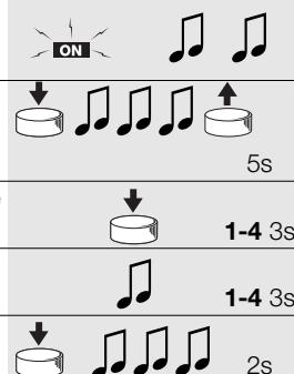
**N.B.:** Als het opslaan in het geheugen tot een goed einde is gekomen zult u 3 lange geluidssignalen horen. Als u op punt 4 niet het juiste aantal geluidssignalen hoort dat overeenkomt met de gewenste bedieningsopdracht, dient u enkele seconden te wachten alvorens de procedure te verlaten, zonder de geheugenopslag te bevestigen.
