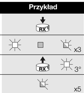
**Uwaga:** Gdy procedura została wykonana prawidłowo to po krótkiej chwili dioda błyśnie 5-krotnie
