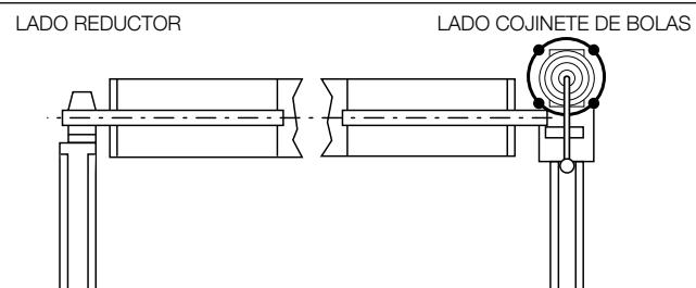
03. Fijar los soportes de fijación; el motorreductor se puede colocar en posición horizontal o vertical: es importante que el eje de bobinado esté horizontal y nivelado.
