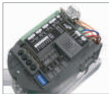
Wbudowana centrala sterująca ułatwiająca programowanie
